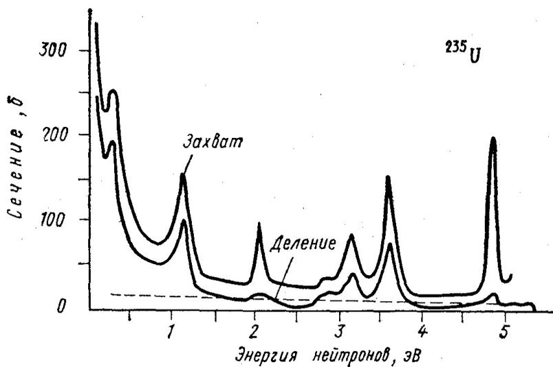
Рис. 7.5: Зависимость сечения захвата и сечения деления  $^{235}_{92}\text{U}$  нейтронами от их энергии (верхняя линия — сечение захвата, нижняя — сечение деления). Пунктир — сечение рассеяния нейтронов.
