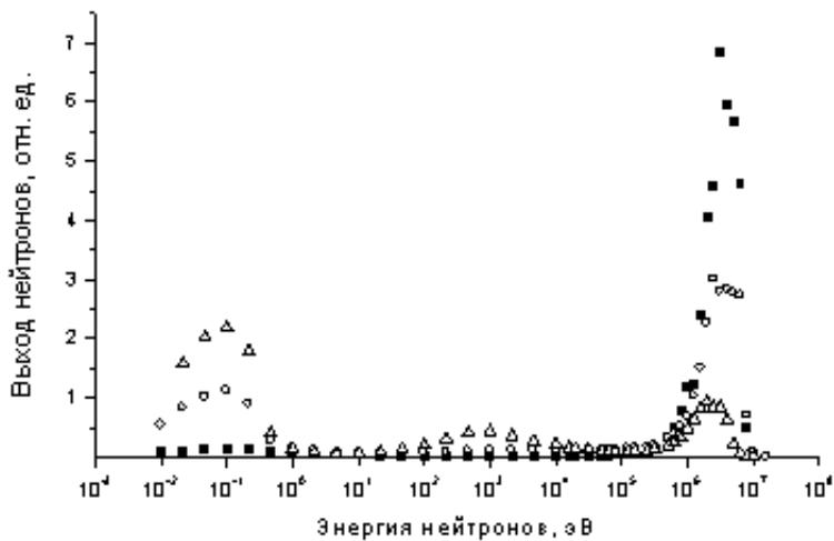
Рис. 7.11: Энергетический спектр быстрых и тепловых нейтронов различных Pu-Be-источников: ■ — источник без замедлителя, ○ и △ — источники с замедлителями (25-см слой воды и тяжелой воды, соответственно).
