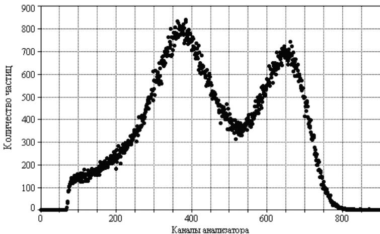
Рис. 7.13: Спектры осколков деления  $^{236}_{92}\text{U}$ . Время набора 18 часов (пример)
