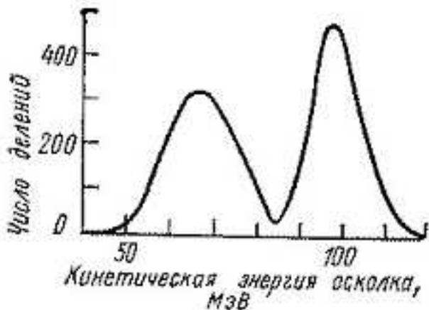
Рис. 7.8: Распределение по энергии осколков деления  ${}^{235}_{92}\text{U}$  тепловыми нейтронами
