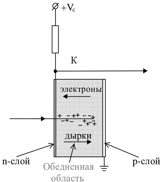
Рис. 7.15: Схема полупроводникового детектора.
