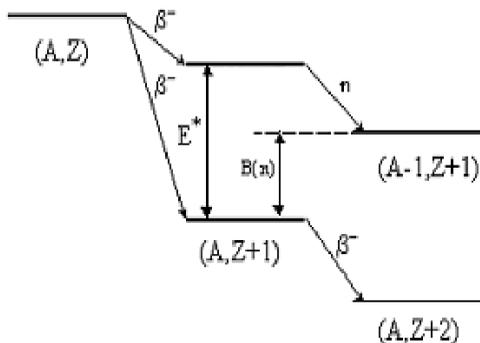
Рис. 7.9: Схема образования запаздывающих нейтронов:  $E^*$  - энергия возбуждения ядра  $(A, Z+1)$ ;  $B(n)$  - энергия отделения нейтрона в ядре  $(A, Z+1)$ ;  $E_n$  - кинетическая энергия запаздывающего нейтрона
