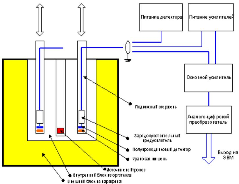
Рис. 7.10: Блок-схема установки для измерения спектра осколков деления.
