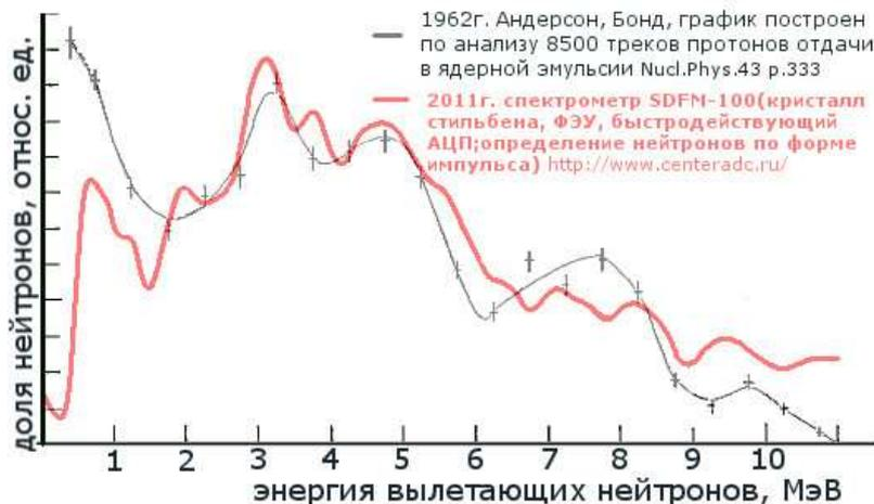
рис.6а Спектр нейтронов  $Pu-Be$  источника.
