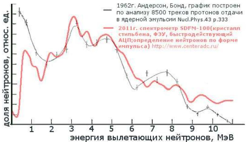
рис.6а Спектр нейтронов  $\text{Pu-Be}$  источника.
