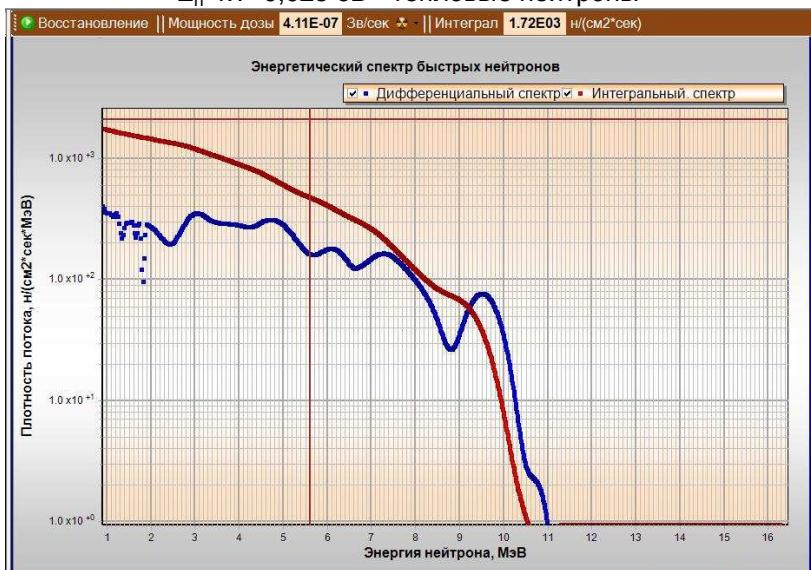
рис.6б Спектр нейтронов  $\text{Pu-Be}$  источника в этой лабораторной работе
