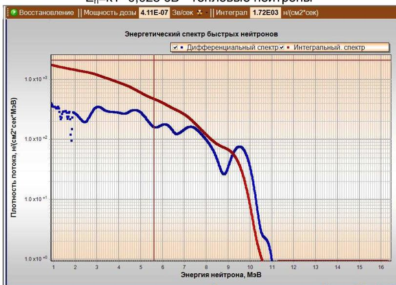
рис.9б Спектр нейтронов Pu-Be источника в этой лабораторной работе
