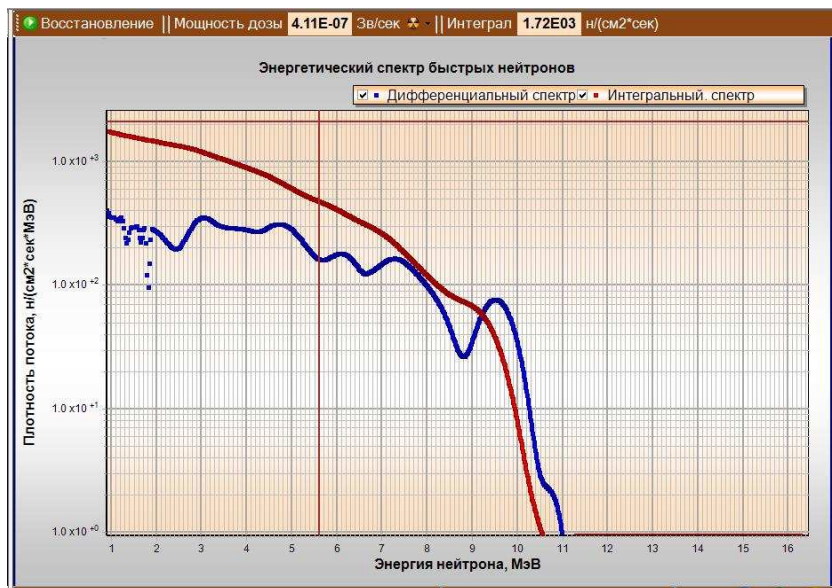
рис. 4.1. Спектр нейтронов Pu-Be источника в этой лабораторной работе
