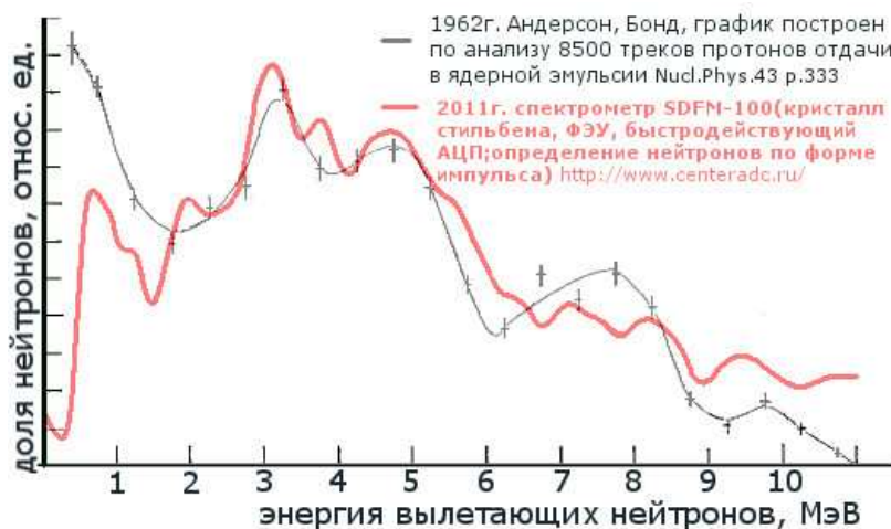
рис.3.4 Спектр нейтронов Pu-Be источника. E_n > 1 кэВ - быстрые нейтроны; E_n = kT \sim 0,025 эВ - тепловые нейтроны
