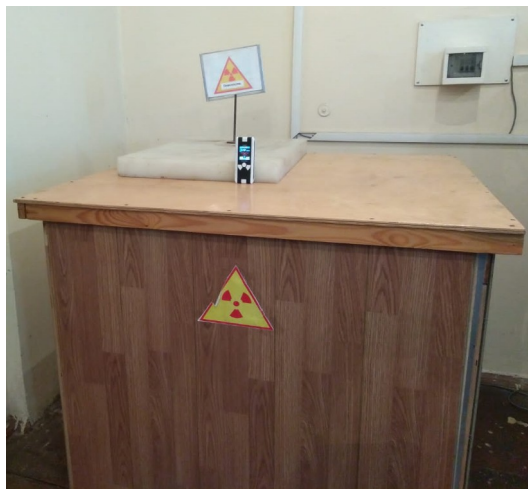
рис. 2а. Плутоний-бериллиевый источник нейтронов в защитном блоке из оргстекла, парафина, кадмия и свинца
